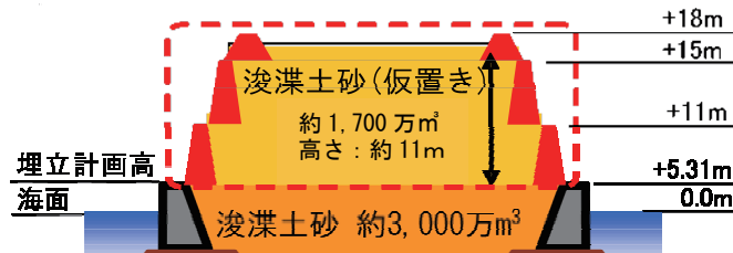
図 13：浚渫土砂仮置きイメージ（断面図）
