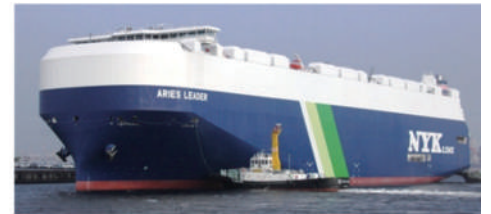
邦船社 7,000台積級 自動車専用船 「ARIES LEADER」(日本郵船) 総トン数:69,931トン 全長:199.98m 幅:35.80m 喫水:10.4m
