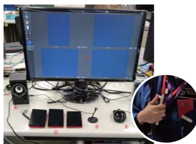
▲搭乗員の胸ポケットのスマホを遠隔操作し、現場の動きを撮影します。撮影した動画は学内のサーバーに転送されます。
